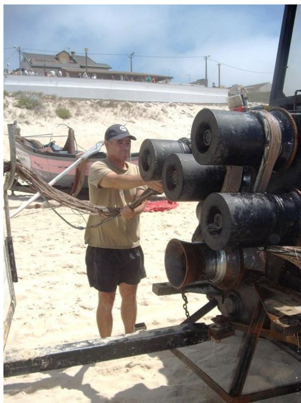
Detalhe significativo das engrenagens acopladas à parte de trás do tractor e que facilitam o processo da recolha das redes.
