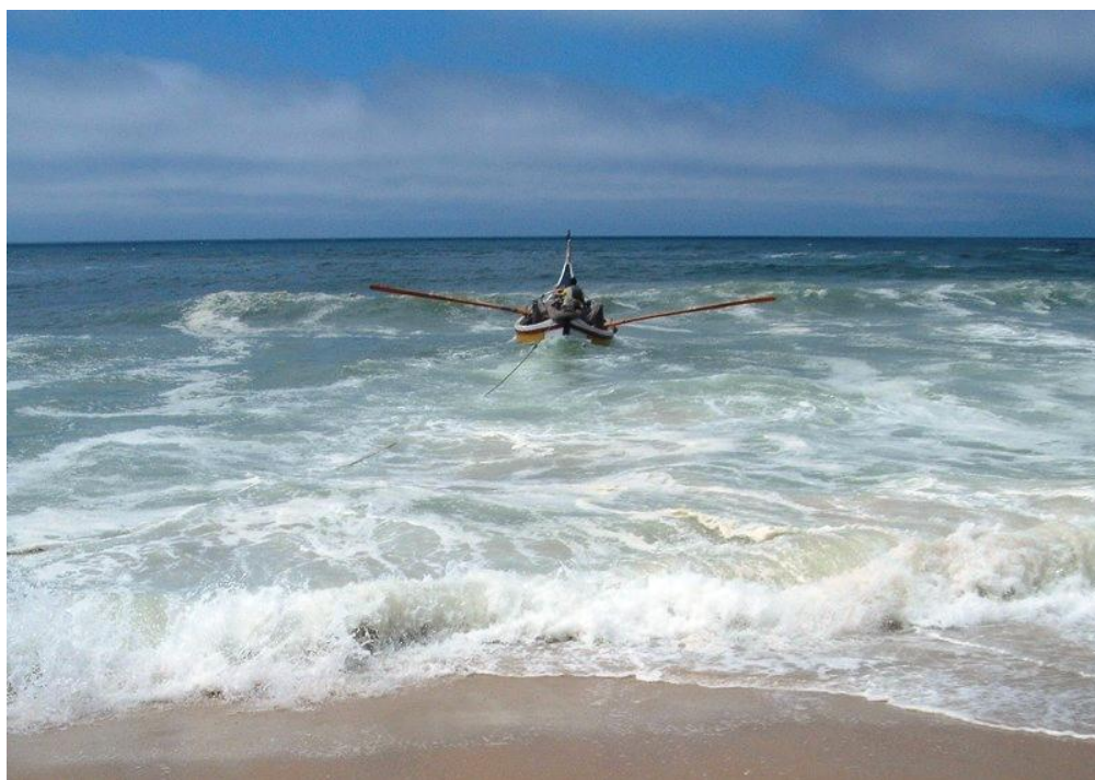
A entrada do Viking no mar. Os remos têm presença obrigatória e vão sempre naquela posição. A corda que está visível fixa no areal uma das extremidades da rede de arrasto para terra.
