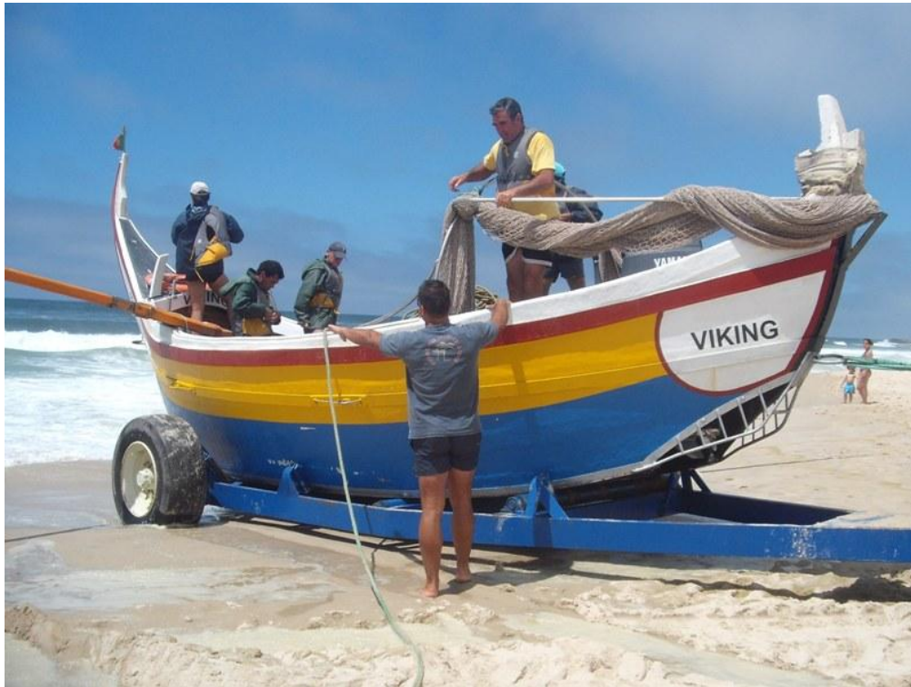
O barco meia-lua Viking , homónimo do que se encontra na rotunda de Vieira de Leiria. As cores das pinturas respeitam as que antigamente se usavam. À ré, o barco exhibe um corte e uma protecção, apropriadas para acomodar e proteger o motor da embarcação.
